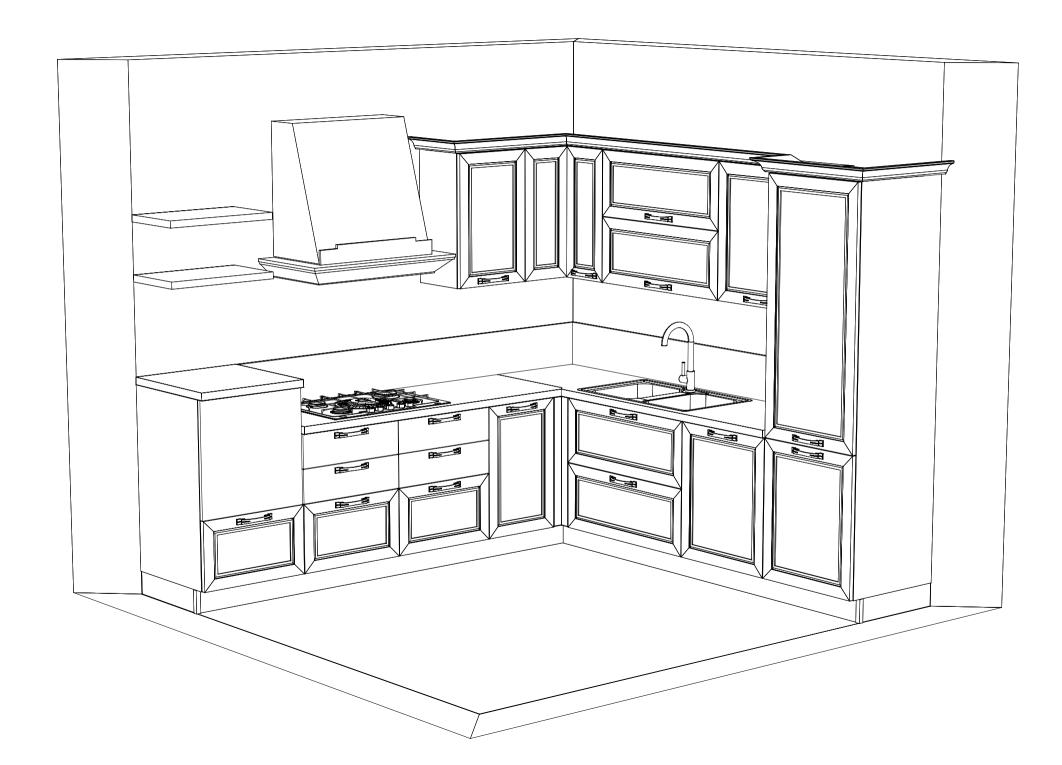
Data Creazione Disegno 05/08/2022 Dimensioni stanza 7.9186 mg Scala 1/30 Misure in mm Presa Acqua Q— Attacco Gas Cappa Camino
